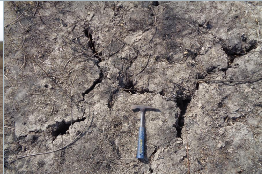
Grietas generadas por humedecimiento y desecación del suelo arcilloso, algunos materiales líticos descendieron hasta 80 cm de profundidad
