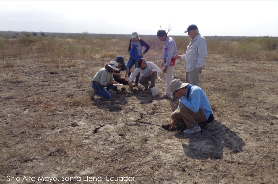
Grietas generadas por humedecimiento y desecación del suelo arcilloso, algunos materiales líticos descendieron hasta 80 cm de profundidad
